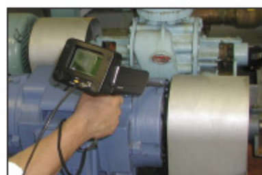
Diagnostika ložiska pomocí Ultraprobe 10000
